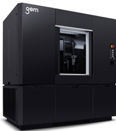
Der GOM CT digitalisiert komplexe Bauteile inklusive Innenleben und macht feinste Details sichtbar. (Bildquelle: GOM GmbH)
